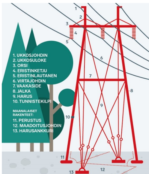
Kuva 3-3. Voimajohdon osat (Fingrid 2021).
